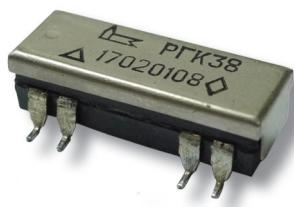
Слаботочное, электромагнитное, герконовое, неполяризованное, одностабильное, негерметичное, в пластмассовом корпусе, постоянного тока с одним замыкающим контактом.
